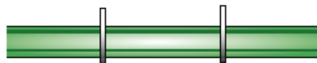
potrubie so sklovláknom asi o 30% väčšie odstupy jednotlivých závesov
