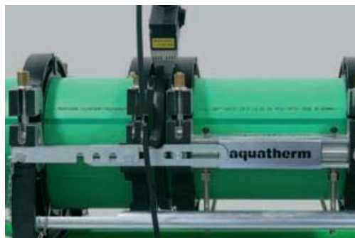
Vloženie vykurovacieho elementu
