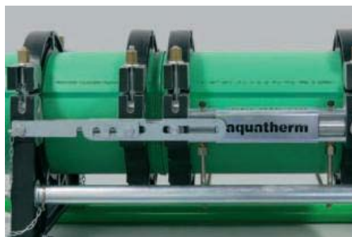
Potrubie stlačiť a za prítomnosti tlaku nechať vychladnúť
