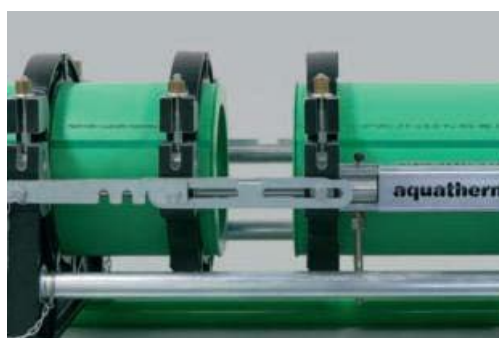
Potrubie k sebe pritlačiť, vykurovací element vybrať
